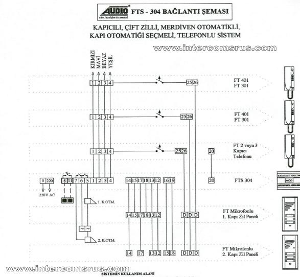
Iki giriş kapısı bulunan, daire kapılanını tek merdiven boşluğuna açıldışt binalarda, dairenin kapı ve kapıcı ile, kapıcının da kapı ile konuşmasında, daire içinden merdiven otomatiğini ve otomatik olarak seçilen kapıyı açınada kullanılır.
